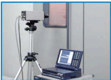
恒温箱内待测物的振动测定
