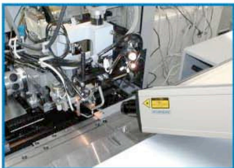
丝焊机焊针的振动测定
