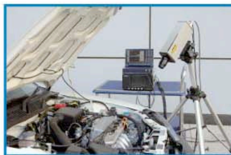
车体和发动机的振动测定
